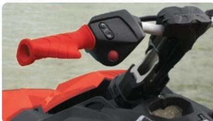
**Система регулировки дифференциала VTS™** с расширенным диапазоном
